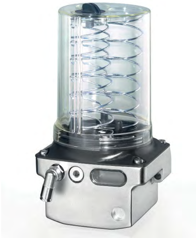
FlexxPump 401 B: autarker, zeitgesteuerter Nachschmiergeber Fett für bis zu 4 Schmierstellen; für 400 cm 3 Kartusche; PA Gehäuse-Abdeckung (grau); ohne M12x1-Stecker; 3V Batteriebetrieb; (abgebildet: 135-140-000)
