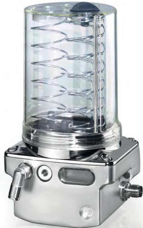
FlexxPump 401 zeitgesteuerter 24V DC Nachschmiergeber Fett für bis zu 4 Schmierstellen; für 400 cm 3 Kartusche; Metall Gehäuse-Abdeckung; (abgebildet: 135-140-101)
