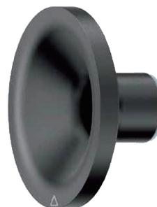
標準のクーラントフラッシュディスクがミクランにも使用できます。クーラントスルーホール (穴) の無い切削工具でも単に外部から切削工具の先端にクーラント液を供給するよりもクーラントフラッシュディスクを使用して切削工具の外周から材料まで正確にクーラント液を供給できるシステムは切削性能を向上させ、刃物の持ちを良くし、より高い精度の加工を可能にします。
