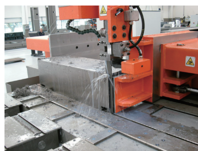
AST 機でチタニウム切断 (Ti64) 切断率 154cm 2 /min と実現
