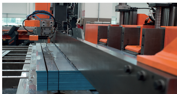
重ね短冊切断で切断効率 UP
