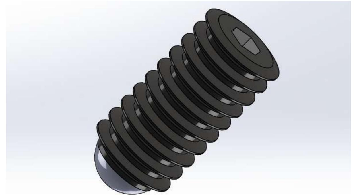
球端面ネジを使用することでインサートホルダー及び偏心ブッシングを固定工具に正確に取り付けることができます。また、偏心ブッシングを使用してY軸方向のエラーを修正する必要がある時、これはインサートホルダーの位置を保持する機能を有していることで偏心ブッシングの調整を容易にします。
