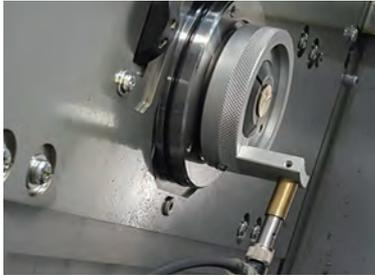
2) センサーリングを取り付けネジで固定する。センサーリングをプラススリーブに入れて固定する。
