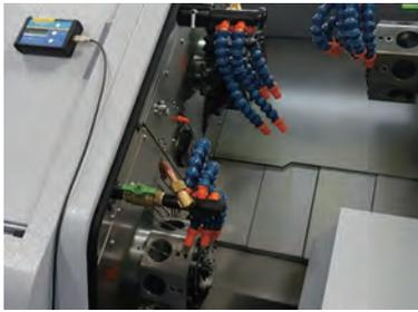
1) マグネット付きディスプレイを機械本体に据付センサーからのケーブルをUSB端子に接続する。
