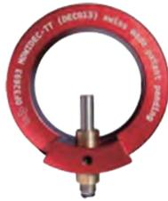
5) 180度センサーを回転させて6時に位置に移動させ数値を読む、12時と6時に差の半分が芯ずれです。芯ずれを調整しリセット”押し、再度12時に位置で測定し調整します。これを繰り返して上下に芯を出します。
