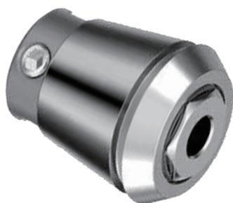
コレットチャックをこのタッピングコレットに入れ替えるだけでコレットホルダーがタッパーとなり、タップ加工ができます。タップの加工はタップが入る時にはネジピッチの0.95%の送りで加工し、戻す時にはネジのピッチで戻すことで簡単にタップ加工が行えます。
