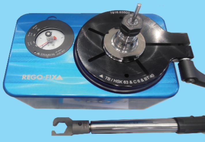
従来、コレットホルダーのナットの締め付けトルク、プルスタッドボルトの締め付けトルクを正確に行うにはトルクレンチが数多く必要でした。この不便さを解決する為に開発されたのが"トルコブロック"です。1台のトルコブロックで殆んどのテーパー (BT,SK, HSK, CAT,CAPTO など) や異なったサイズのコレット (ER-11 から ER32 まで) にも対応できるトルク管理装置です。各メーカーの専用スパナや市販のスパナを使用できる装置は世界市場唯一の製品です。より高精度、高速化が要求される加工には絶対に必要な装置です。
