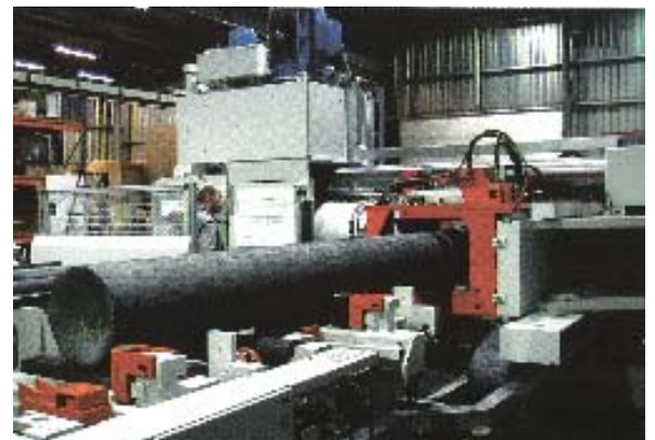
外径 150~500mm、長さ 18m、最大温度 400℃の鍛造棒材用曲がり矯正機
