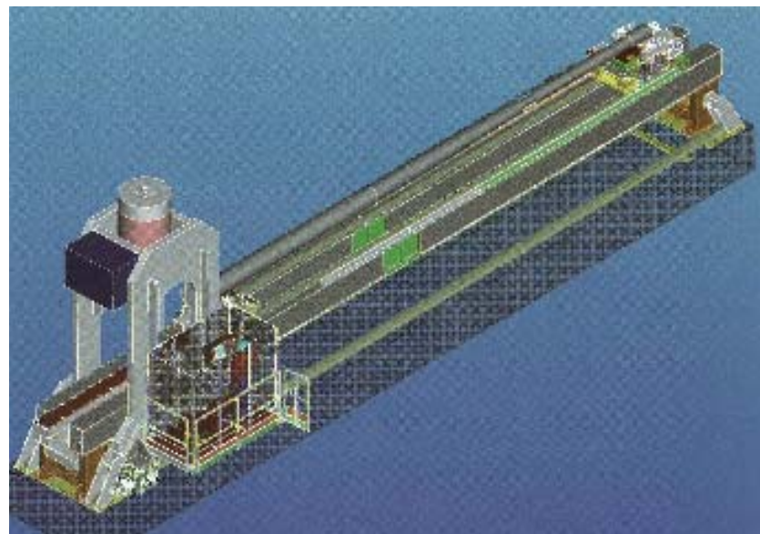
大径棒材、肉厚のパイプで外径 500mm \Phi 長さ 12m。ガントリー型、全自動曲がり矯正機
