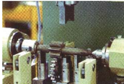
ギアポンプ軸 1点曲がり矯正 精度 10 \mu m 生産数 240 個 / 時間
