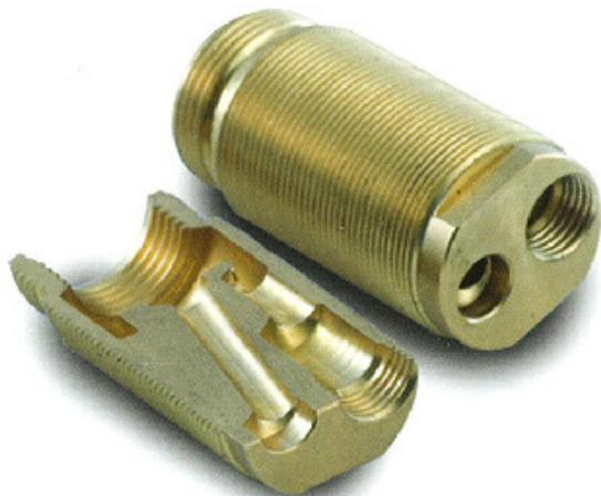
傾斜したり中心に無い機械加工はロータリー工具の使用で単純化されます。複雑な加工を一回のクランプにより再クランプで発生する誤差を無くす事が可能になり、工程の間でより良いアライメントを実現できます。
