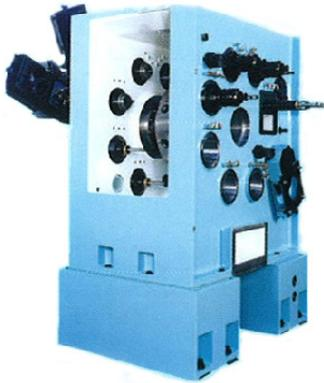
二重フレームはスピンドル間の振動を排除する様に設計されています。粗加工での重切削も高精度の仕上げ加工と同時にこなわれても高品質部品に影響が出ません。
