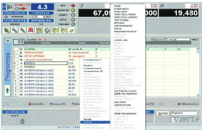
ユーザーフレンドリープログラミングにより非常に高い効率のプログラムができます。(G.Mコードは使用しません) 画像によるメニューでオペレーターは段階的な入力でプログラムが完成できます。工具達成モードで半自動で寸法データを取得します。工具の軌跡はスクリーンで確認できます。迅速に取得でき単純に操作できる特徴のある制御装置です。ウィンドーズの機能、コピー、ペースト、カット、挿入、削除などによりプログラム時間と努力が大幅に削減できます。ラップトップパソコン、ローカルネットワークの利用で容易に外部でプログラムを組む事ができます。
