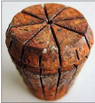
標準ERコレット / 素材:一般的なばね鋼
