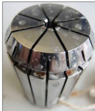
レゴフィックス製ステンレスERコレット / 素材: DIN1.4122
