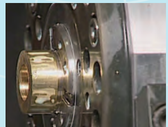
下の写真の ② のジョーからコレットへ掴め替えを機内で行っています
