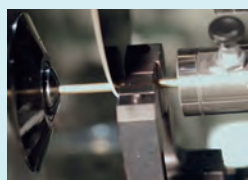
材料を丸鋸で切断
