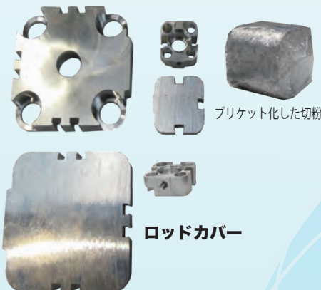
側面加工とロット穴仕上げ、ネジ加工を同時に行う
