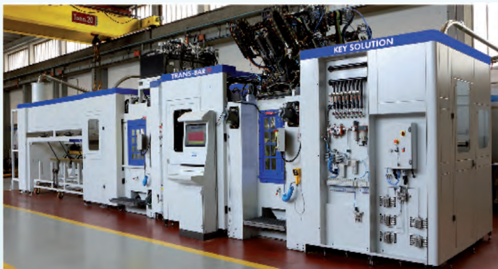
バー材またはコイル材からキー本体およびプラグを製造する機械
