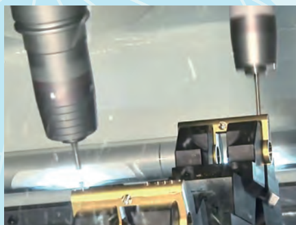
最大 36000\text{min}^{-1} で回転する高速スピンドルで大量のドリル加工も短時間で完了
