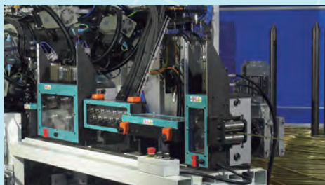
コイル材も加工できる多軸複合加工機
