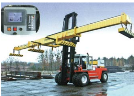
フォークリフトでの大型鋼板搬送
