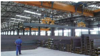
チャンネルの束の搬送
