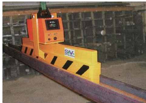
切断された型钢の搬送、ポールシューを交換することで寸法の異なる型钢の搬送ができます。
