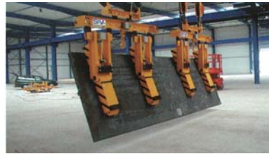
鋼板水平・垂直搬送
