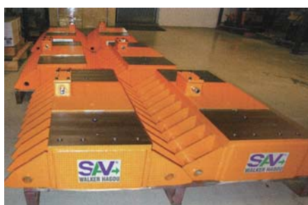
ロールミル後のシャーリング工程前の鋼板のアライメント調整用特殊マグネット搬送装置
