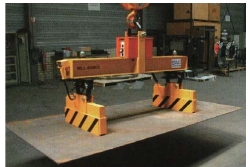
長いビームに2個のマグネットを使用、マグネットモジュールを回転することで小さい鋼板の搬送ができます。
