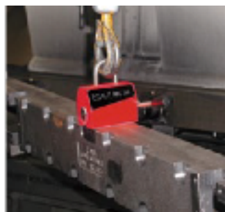
NEO300: 鋳物材のマリニングセンターへの搬送
