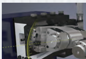
サーボモーターで任意の角度調整可能
