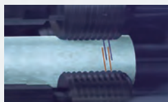
ピッチズレ (ダイスのピッチ合わせ不良)
