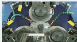
3ダイス転造盤用自動ピッチ合わせ
