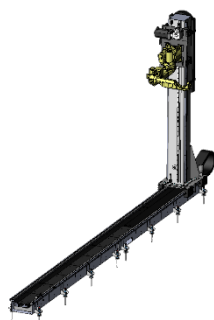
3D 測定カメラ搭載ロボット 走行による大型ワークの測定
