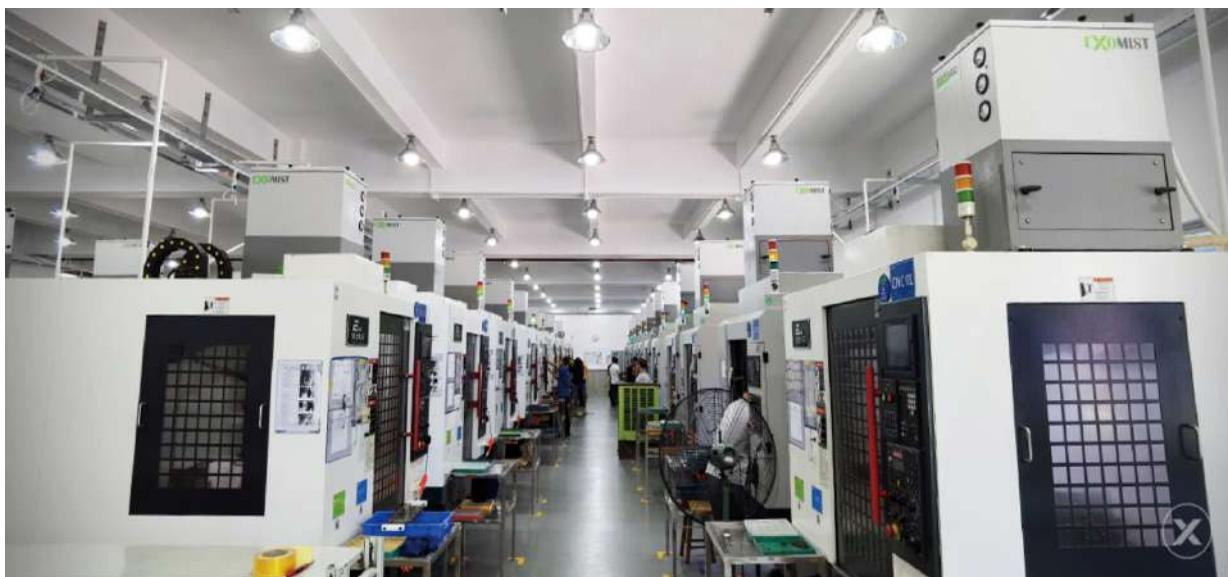
旋盤加工、マシニング加工、研削加工では様々な成分の切粉、粉塵、飛沫が発生し周辺の空気に放出されます。室内の空気中に放出された粒子は無害な物ではなく空気濾過装置で除去しなければなりません。水蒸気のほか、油滴や、冷却用潤滑油の濃縮液などに添加されている化学物質、いわゆる添加剤があります。また、冷却水から真菌やバクテリヤが検出されることもあります。これらの粒子は蒸発と乱流によって、すぐに従業員の鼻や肺に入り込んでしまいます。それらの不純物を空気中に放散さない為には適切な規格に合格したミストコレクターを使用することが重要です。
