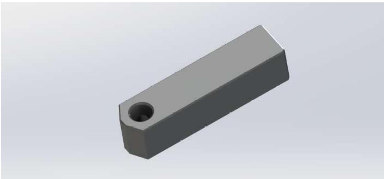
マシニングセンター等での加工時にこれを使用することで加工軸の修正を容易にし、より正確なツールプリセットを実現します。インサートの代わりにインサートホルダーに取り付け、ゲージ等を使用してプレート側面にて計測を行うことで、ワークの基準軸に対してインサートホルダーを正しく取り付けることができます。
